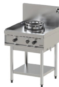
NGER 7-70 Δαπέδου, 1 εστία αερίου 13Kw. Με βρύση νερού και κρουνο εξαγωγής. Διαστάσεις: 70x70x85/115cm
